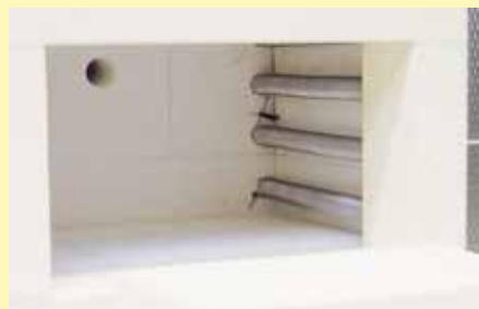
Intérieur du four avec isolation en briques réfractaires légères de qualité supérieure
