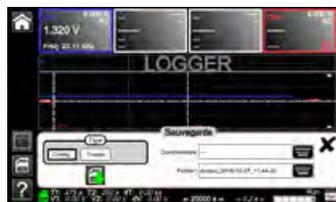
Mode Logger : enregistrement des tendances du mode multimètre, basculement facile d'un mode à l'autre.
